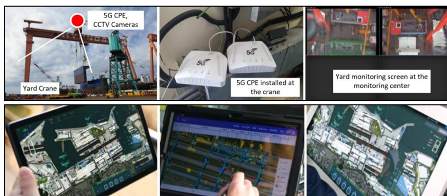
รูปที่ 2.5 การติดตามไจต์งานแบบเรียลไทม์จากกล้องที่ติดตั้งบนเครนในอุต่อเรือ HD Hyundai Heavy Industries และ HD Hyundai Mipo ณ เมืองอุลซาน (Ulsan) ประเทศเกาหลีใต้ (ที่มา : netmanias)
