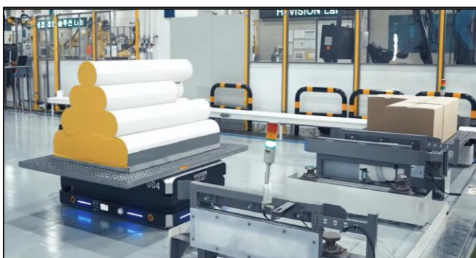
รูปที่ 2.2 หุ่นยนต์ขนส่งเคลื่อนที่อัตโนมัติในโรงงานผลิต ณ เมืองอุลซัน (ที่มา : Hyundai Motor Group)
